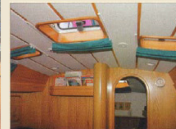
L'isolation entre les vaigrages et le pont en alu offre un vrai confort thermique et acoustique.
