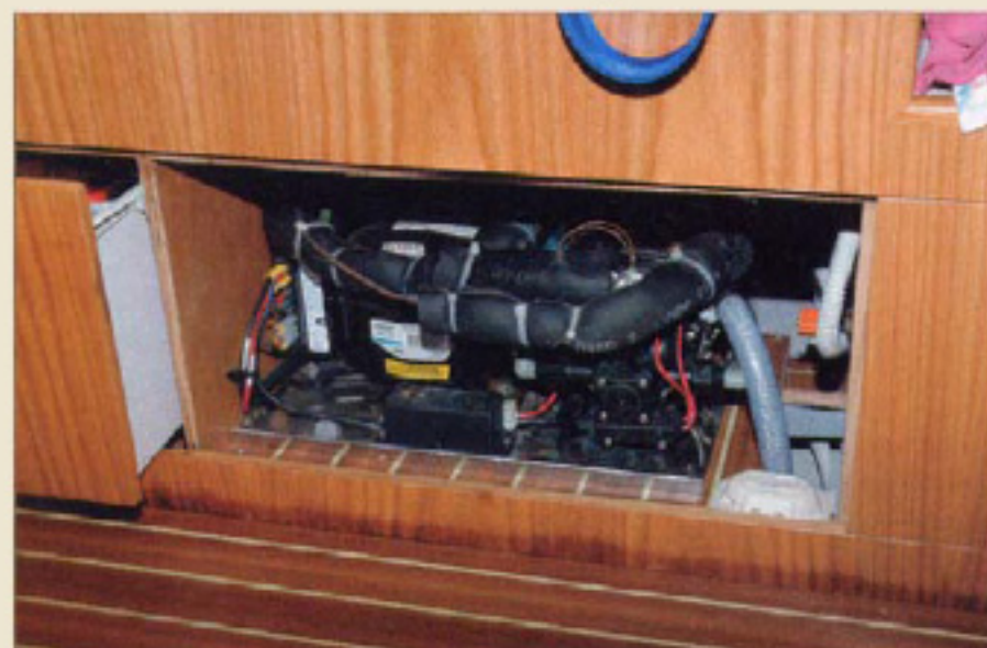
De l'eau stagne sous le moteur du frigo et le bois est marqué.
