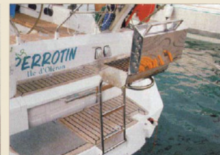
Le barbecue fixé sur l'échelle de bain bascule en cas d'incendie ou après la cuisson pour vider les cendres.
