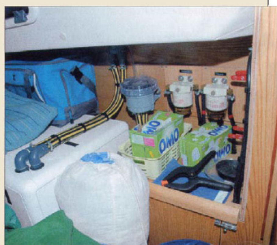
Pour éviter les galères, les filtres des moteurs doivent être facilement accessibles.
