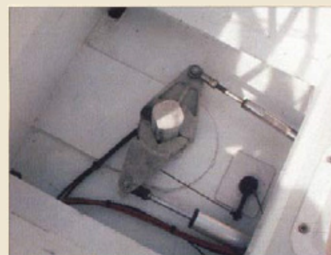
Un carré de barre très accessible permet d'intervenir rapidement sur la tringle de direction ou sur le pilote.
