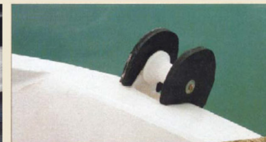
Le davier sur jupe s'impose avec un dériveur intégral : il faut pouvoir mouiller par l'arrière.
